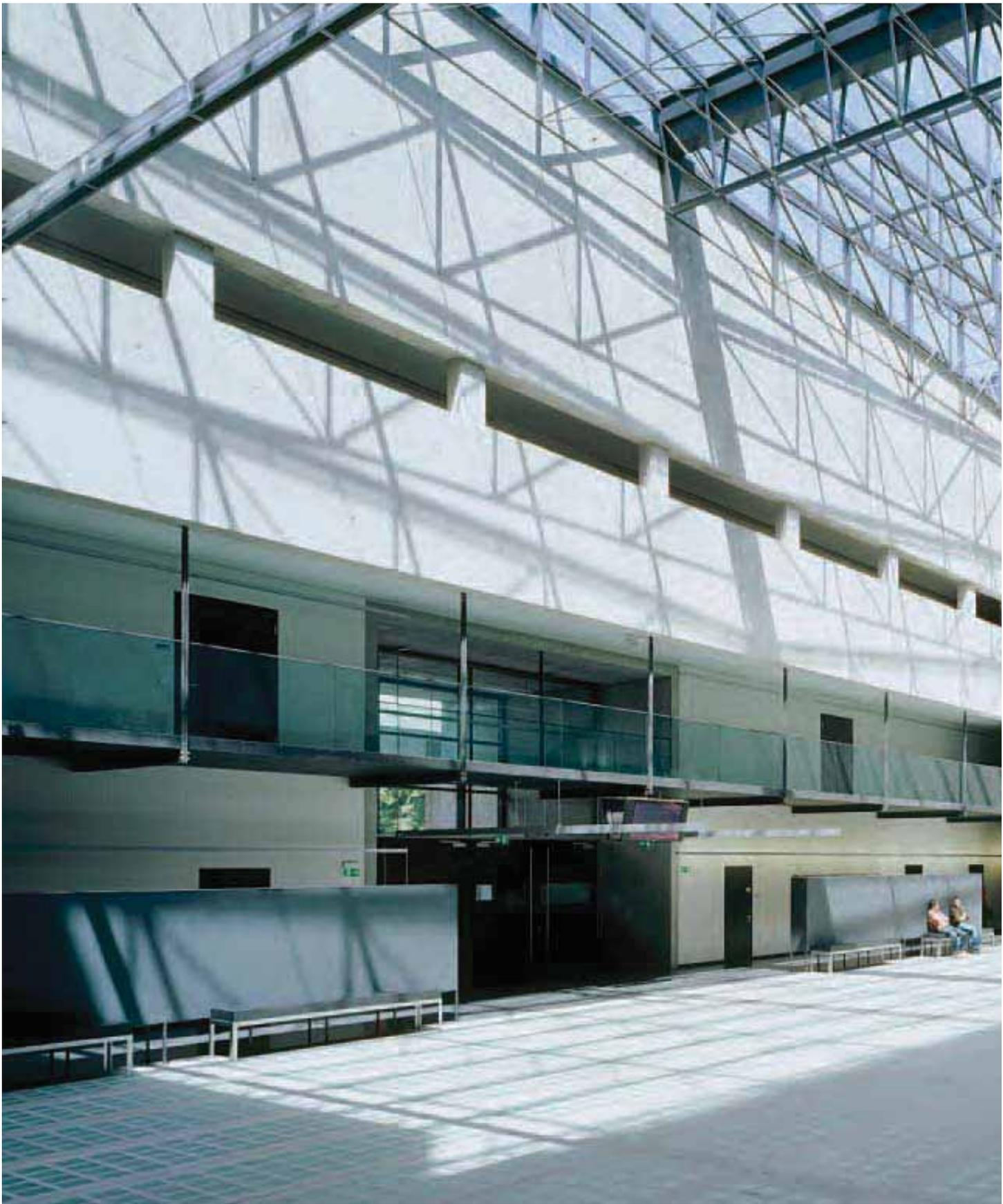
*Il grande atrio, alto quattro piani, è delimitato dalle ampie superfici in reticolato d'acciaio delle scale e dai corridoi di distribuzione di piano. Alla copertura trasparente che inonda di luce lo spazio interno corrisponde il pavimento di vetrocemento che illumina la sottostante palestra*
