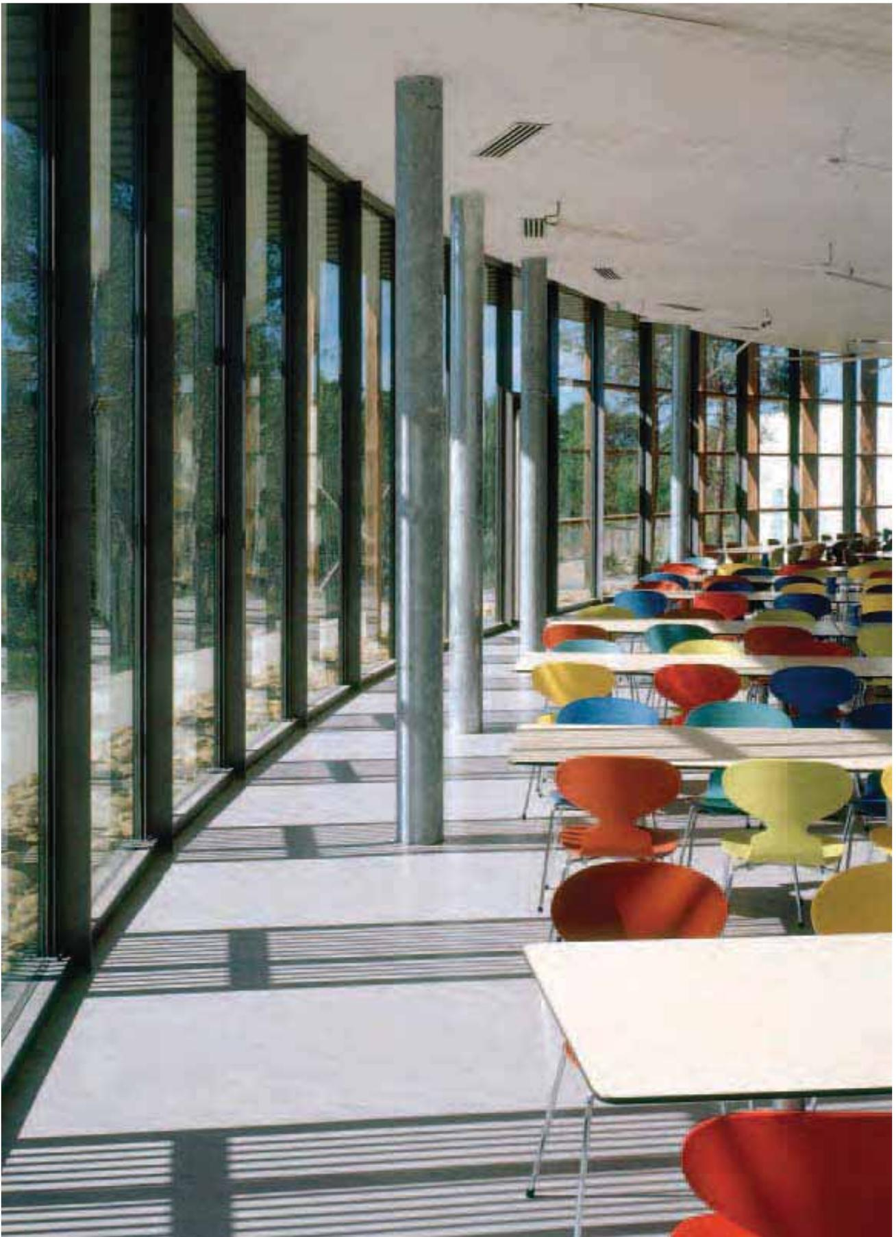
*Il ristorante è chiuso da vetrate basso-emissive combinate con sistemi di schermatura solare*
