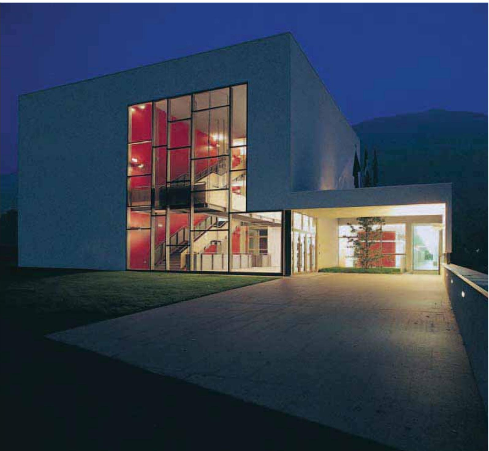
torre al corpo longitudinale delle aule. L'atrio a tutta altezza è caratterizzato da una scala sospesa al soffitto da coppie di tiranti di acciaio, con la struttura metallica verniciata in grigio scuro che contrasta con i parapetti in legno e con la parete di fondo tinteggiata di rosso.
